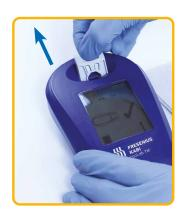
Puxe a parte de trás do suporte de cuveta levemente em sua direção e levante.
