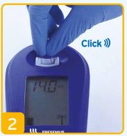
Retire a cuveta do CompoLab TM rapidamente.
