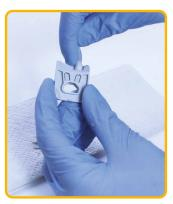
Usando um swab, limpe o suporte de cuveta com água fria ou um detergente leve, seguido por desinfetante. Seque por completo.
