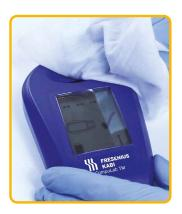
Limpe o dispositivo com água fria ou detergente leve, seguido por desinfetante.
