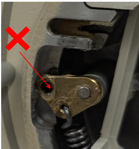
Rysunek 1: Niedopuszczalne nasmarowanie na/blisko brązowym ogniwie
