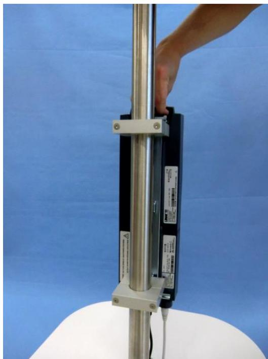
**Abbildung 2: Akku einsetzen / herausnehmen    Abbildung 3: Akku einsetzen / herausnehmen**
