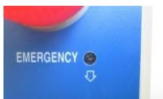
Im Fehler- oder Störfall, kann der Irrigatorständer durch Drücken des Not-Ablass Tasters manuell abgesenkt werden. Dafür ist der kleine Not-Ablass Taster unterhalb des Not-Aus Knopfes mit einem kleinen Hilfsmittel (z. B. Kugelschreiber) zu betätigen.
