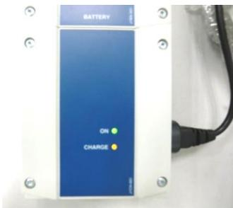
Stellen Sie sicher, dass das Ladegerät wie in 4. Montageanleitung installiert und angeschlossen ist. Die grüne Kontrolllampe (ON) leuchtet. Dann setzen Sie den Akku wie in 5.1 Inbetriebnahme beschrieben in das Ladegerät ein. Jetzt leuchtet auch die orange Kontrolllampe (CHARGE). Erlischt die orange Kontrolllampe ist der Akku vollständig geladen.
