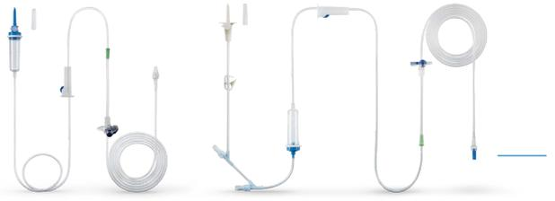
Die Volumat Line AirBlock ist mit einer AirBlock-Membran am Boden der Tropfkammer ausgestattet, welche das Eindringen von Luft in die Leitung und somit ein Leerlaufen des Infusionssets bei Dauerinfusionen verhindert.
